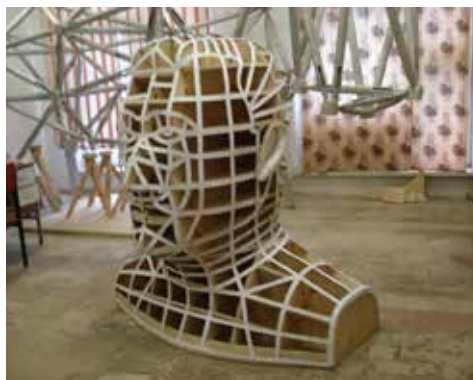
Рисунок 4. Окончательный вариант сетки однослойной оболочки
