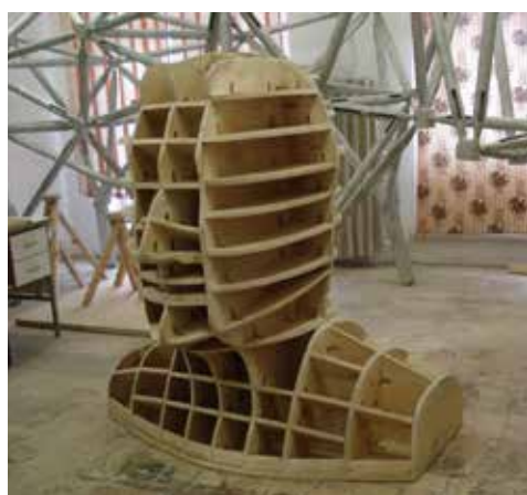
Рисунок 2. 3D модель стапеля и находящейся на нем однослойной оболочки
